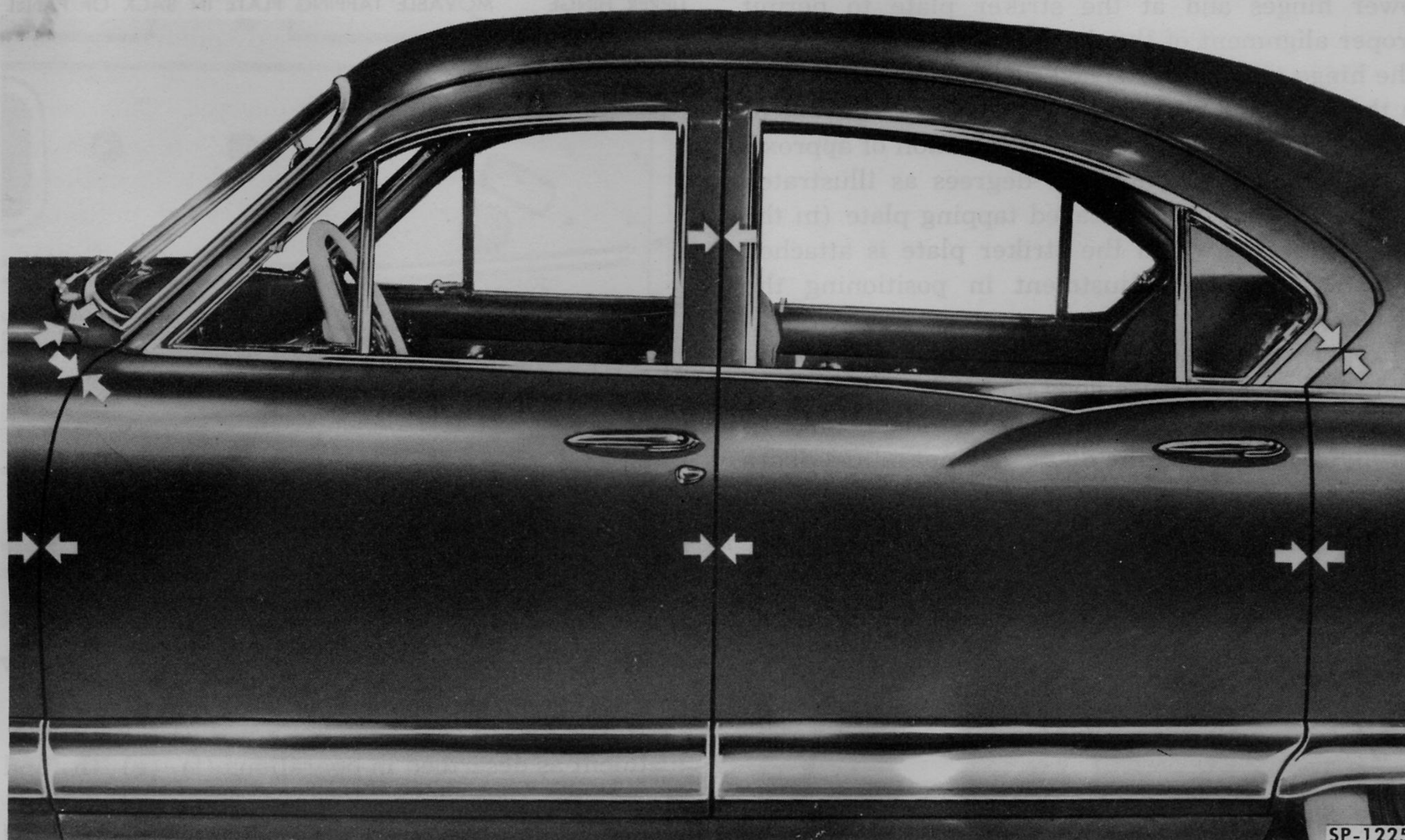
Fig. 342—Spacing for Proper Door Alignment—Kaiser
